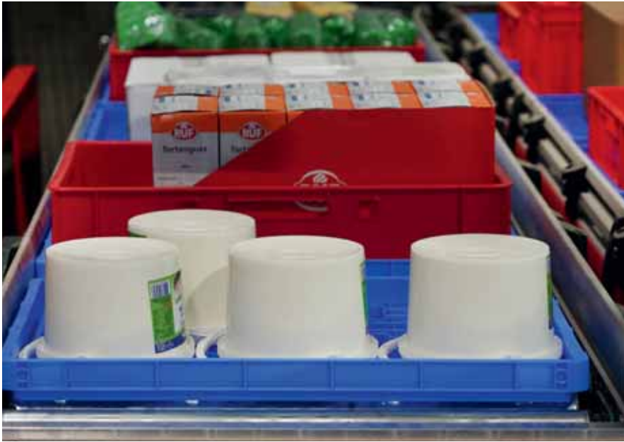
Als Ladehilfsmittel setzt Frischdienst Walther ausschließlich Tablare ein.
