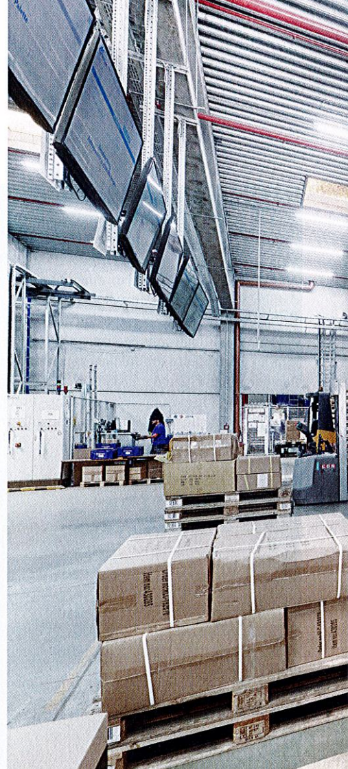
Die fördertechnische Anbindung von – mit Displays ausgestatteten – Multi-Order-Picking-Plätzen für Paletten mit vier Entnahme- und acht Zielplätzen.
