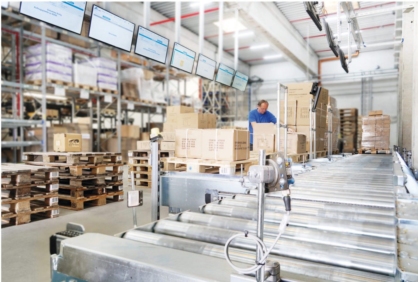
Fördertechnische Anbindung von, mit Displays ausgestatteten, Multi-Order-Picking-Plätzen für Paletten mit 4 Entnahme- und 8 Zielplätzen
