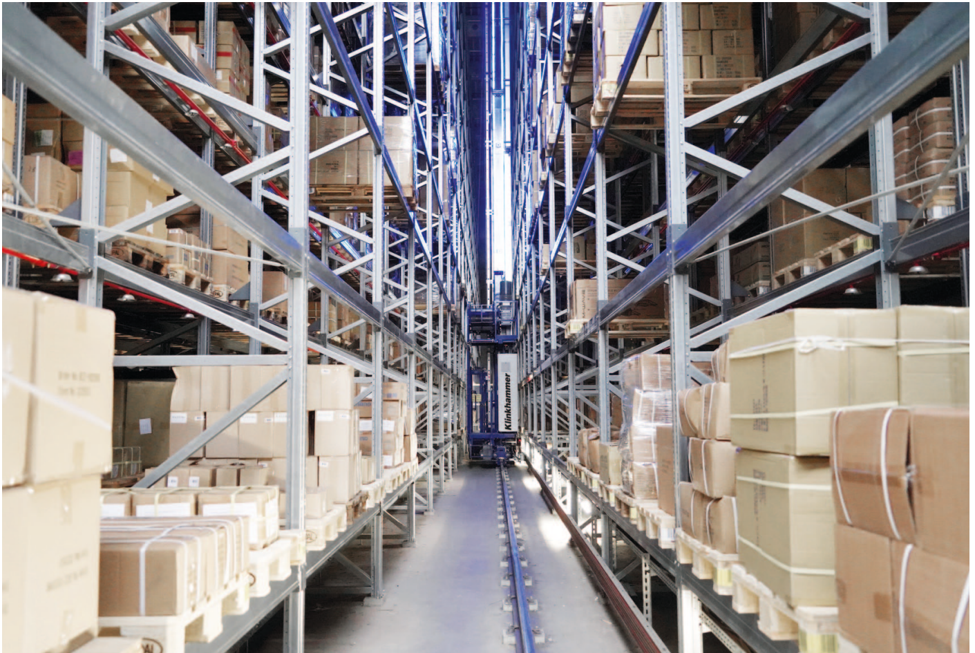
Retrofit des automatischen Palettenhochregallagers im laufenden Betrieb
