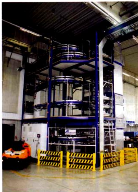
Die Teile-Durchlaufgeschwindigkeit wurde bei Rifag durch die Paternosterlösung von Klinkhammer um 50 Prozent erhöht
