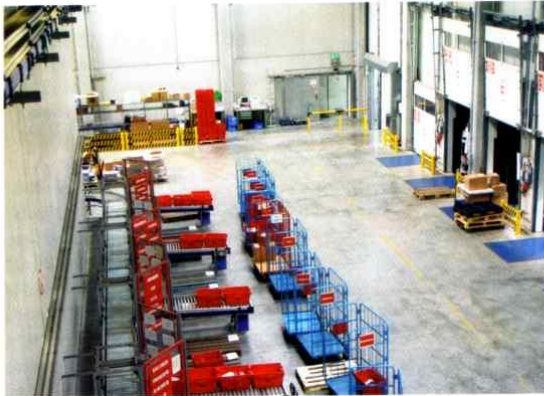
Behälterausschleusung für die Tourenabwicklung: Der Behälterdurchsatz wurde von 400 auf 800 Boxen pro Stunde erhöht
